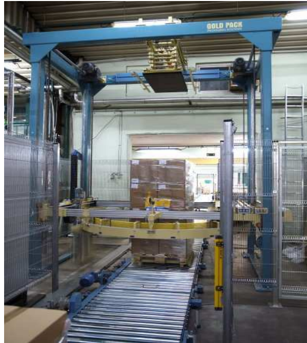
Automata sztreccselő GOLDPACK SIGMA FX Műszaki adatok
